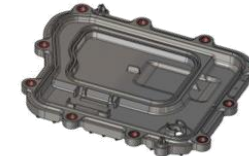
Wanne aus PA66GF60 mit umspritzten Anschrauhülsen aus Aluminium
