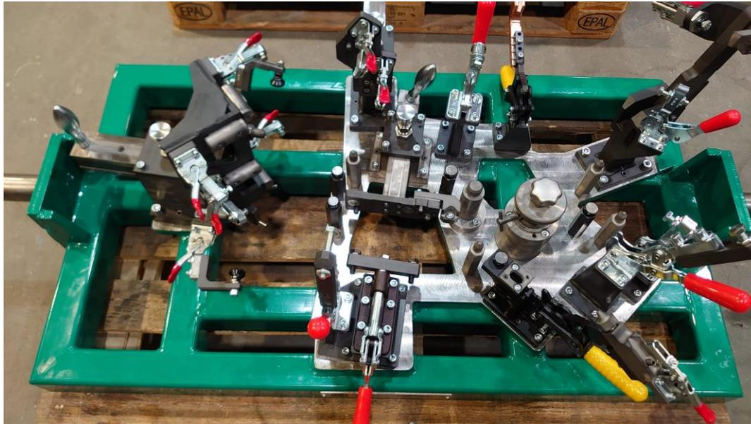
Spanner, Schieber geöffnet / zurückgefahren
