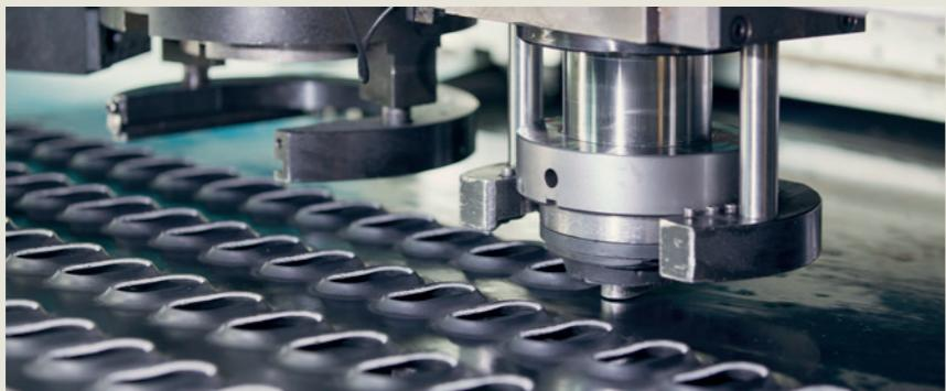
Macchine per la punzonatura per particolari che richiedono piccole deformazioni, imbutiture o maschiature con massima precisione effettuate durante la fase di taglio.
